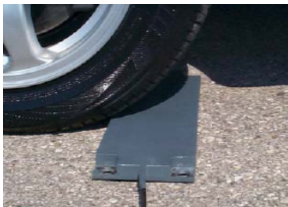
Spínací rohože LMI-CW jako signální čidla při přeježdění ve stanicích technické kontroly
